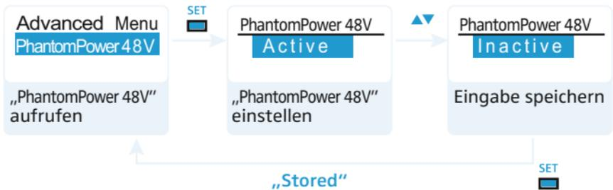
Im Menüpunkt „PhantomPower 48V“ können Sie die 48 V-Spannungsvorsorgung von Kondensatormikrofonen ein-/ausschalten.
