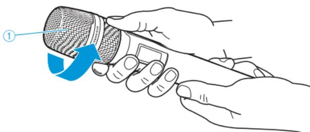
**i** In alcuni moduli microfoni è possibile avvitare la parte superiore della capsula microfonica. Impugnare sempre il modulo microfono come indicato in figura per svitarlo completamente.
