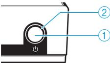
Die Taste Standby
