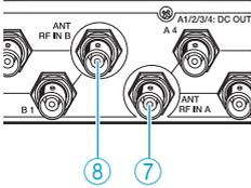
▶ Montieren Sie zwei passive Antennen oder eine Kombination aus passiver Antenne und Antennenverstärker an die BNC-Buchsen **ANT RF IN A** (7) und **ANT RF IN B** (8):
